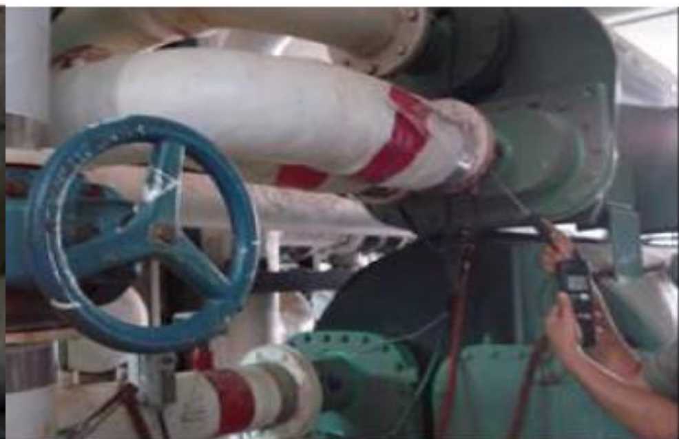
تعیین دمای سطحی لوله‌های آب گرم و سرد
