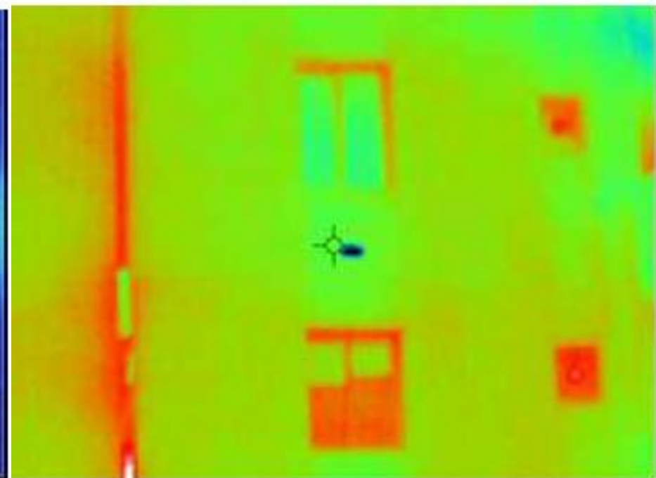
بررسی اتلاف حرارت از پنجره ها
